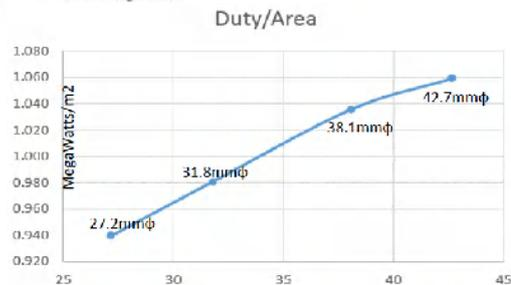
図1: 伝熱管ODと伝熱面積当りの熱負荷(Duty)量の関係
