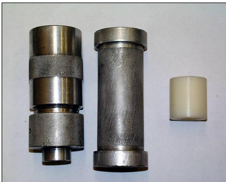
径調整可能なダイス/金属製固定ダイス/ナイロン製固定ダイス(左から)
